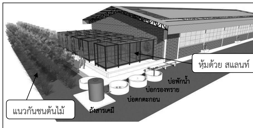
รูปที่ 7.3-8 ม่านกระจายน้ำกำจัดกลิ่นหลังพัฒมโรงเรือน
